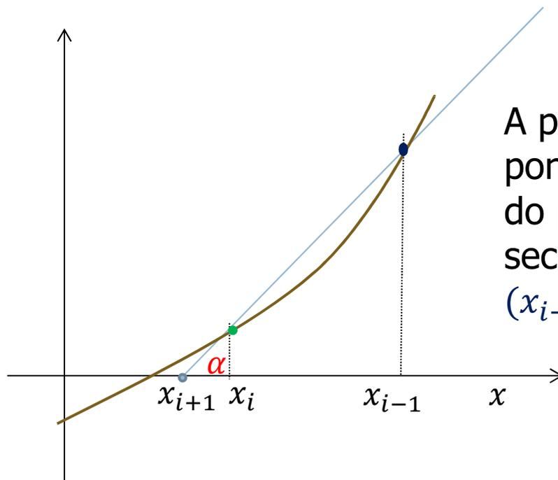
A partir de duas aproximações  $x_{i-1}$  e  $x_i$ , o ponto  $x_{i+1}$  é obtido como sendo a abscissa do ponto de intersecção do eixo x e da reta secante que passa pelos pontos  $(x_{i-1}, f(x_{i-1}))$  e  $(x_i, f(x_i))$
